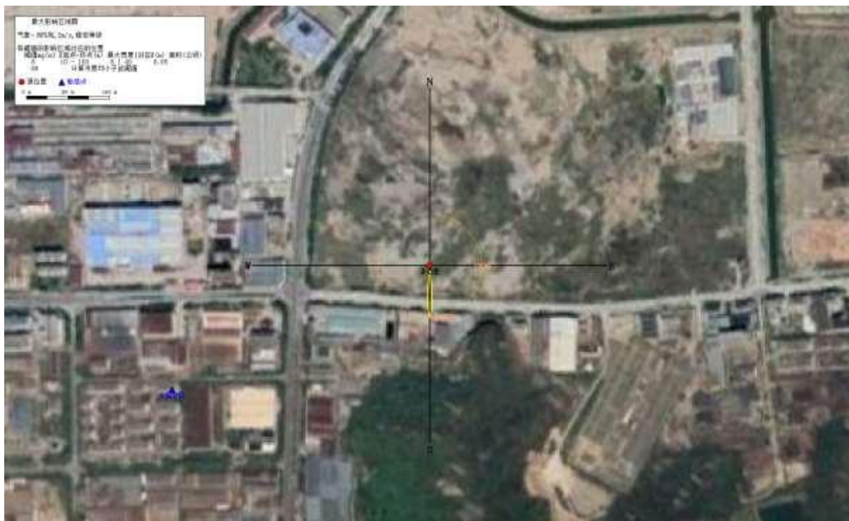
图 8.5-7 顺酐储罐破裂事故最大影响区域（不利气象）
